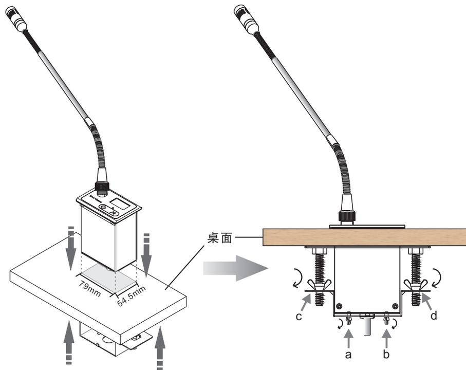
第四步：将单元八芯线放入桌面孔并穿过固定底板预留孔，撕开防水垫保护纸对准桌面开孔放置进去，为确保防水性请用力按压；
